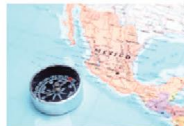
El extremo norte de la brújula es atraído hacia el polo norte de la Tierra (polo sur magnético).
